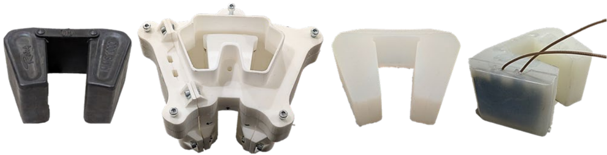
Abbildung 8: V.I.n.r. Originalsattelstollen, Gussform, passiver Sattelstollen aus Silikon, Sattelstollen aus Silikon mit integriertem DE-Sensorelement.
