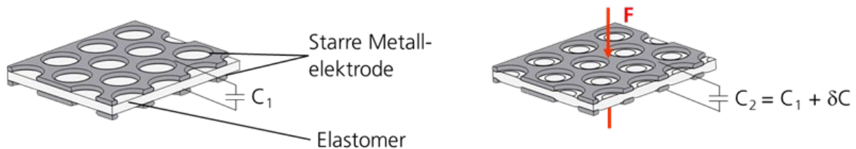
Abb. 1: Funktionsweise dielektrischer Elastomersensoren (mit DELTA-C-Technologie)
