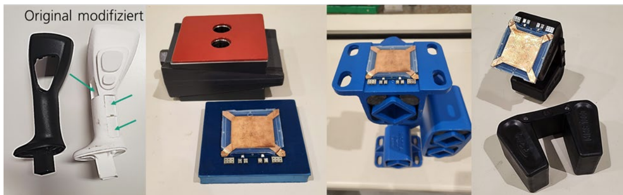
Abbildung 7: Festlegung der Positionierung von DE-Sensoren in den ausgewählten Bauteilen, v.l.n.r.: Joystick-Handgriff, Aggregatlager, Schwingelement, Klauenkupplung-Sattelstollen
