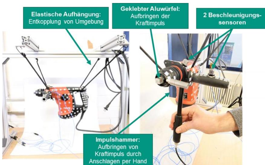
Abbildung 3: Versuchsaufbau der Modalanalyse mittels Impulsanregung. Die Aufbringung des Kraftimpulses erfolgte von Hand.
