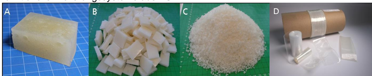
Abb. 5 Verarbeitung von TPU; (A) Blockförmige Probe aus der Synthese, (B) zerkleinerte TPU-Stücke, (C) gemahlenes TPU-Granulat, (D) Folien für die Herstellung der Folierungssysteme © Fraunhofer IAP
