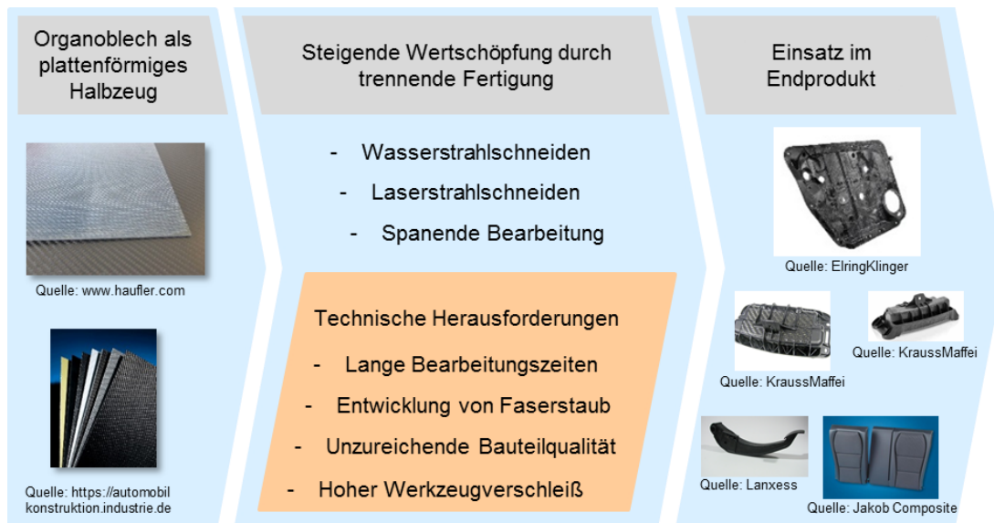
Abbildung 2: Technische Herausforderungen bei trennenden Verfahren von Organoblechen
