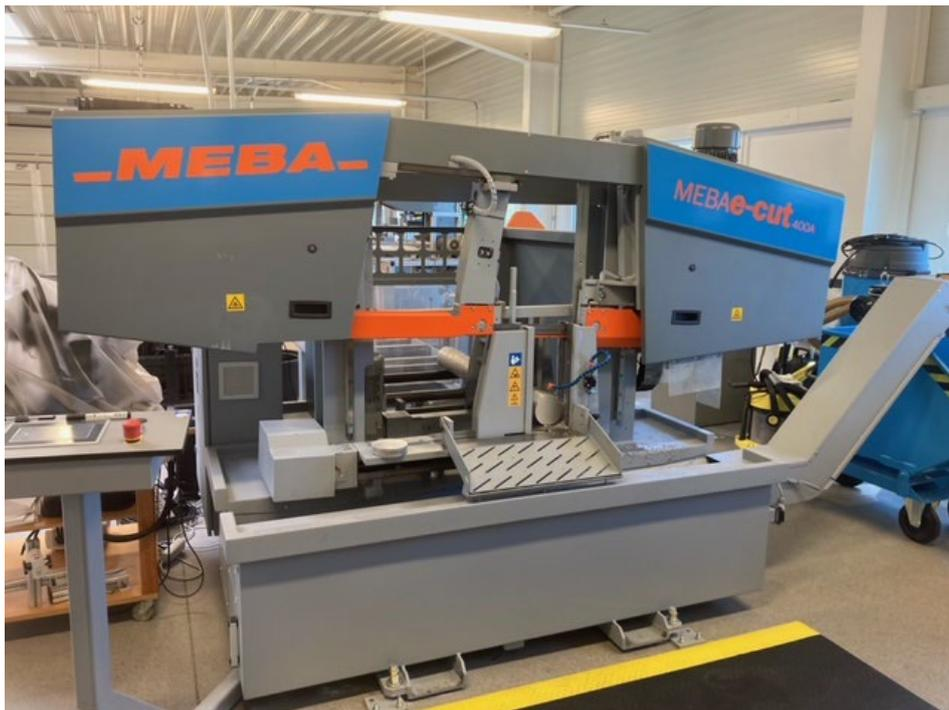
Abbildung 2: Metall-Bandsägeautomat MEBA e-cut 400 A.
