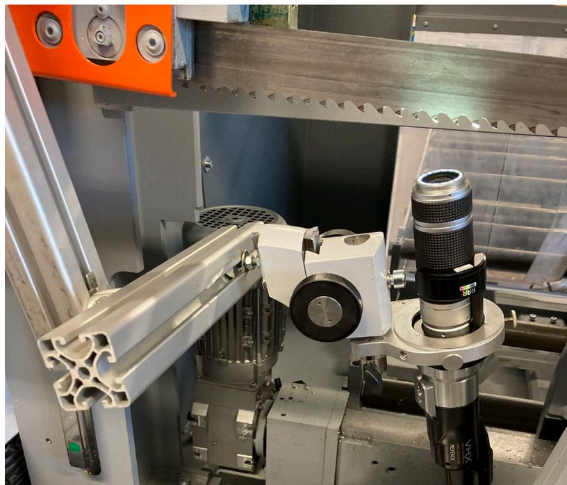
**Abbildung 7: Direkte Bewertung der Schneidzähne nach dem Einfahren an der Meba Sägemaschine.**
