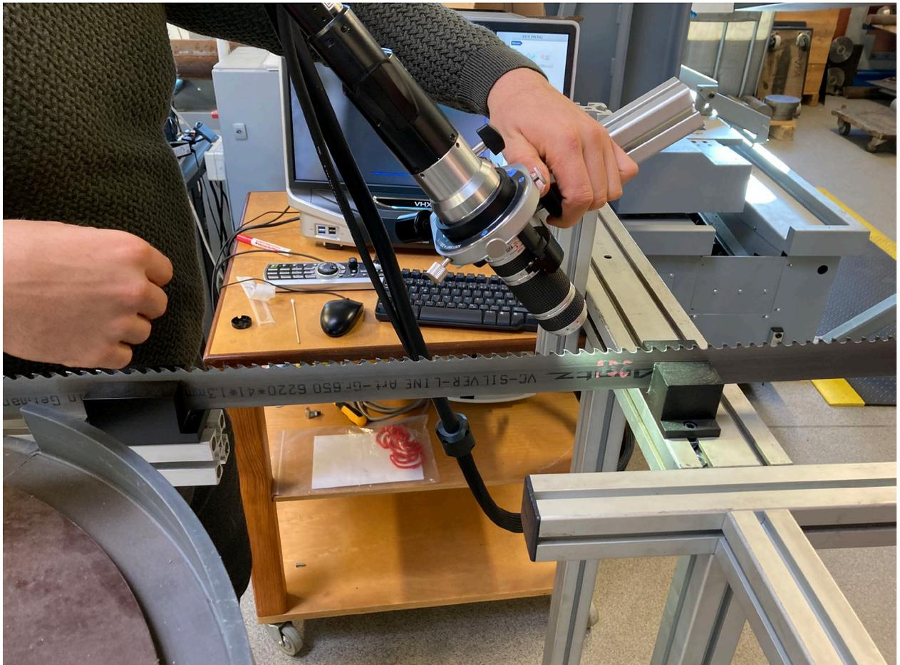
**Abbildung 9: Direkte Begutachtung der Schneidkanten nach der Bestrahlung mit dem Digitalmikroskop.**
