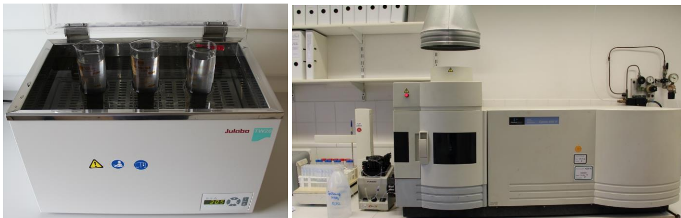
Abbildung 1: Links: Wasserbad mit Messerklingen in Messzylinder; Rechts: ICP-OES-Gerät
