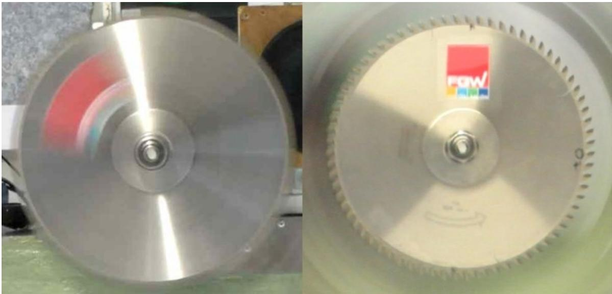
**Abb. 1: Rotierendes Werkzeug (links) optisch in den Stillstand versetzt (rechts)**
