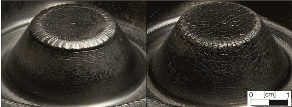
Abbildung 1: Thermoschockbeständigkeit eines vergüteten Dorns (links) im Vergleich zu einem stark nitrierten Dorn (rechts) nach 1000 Schmiedezyklen
