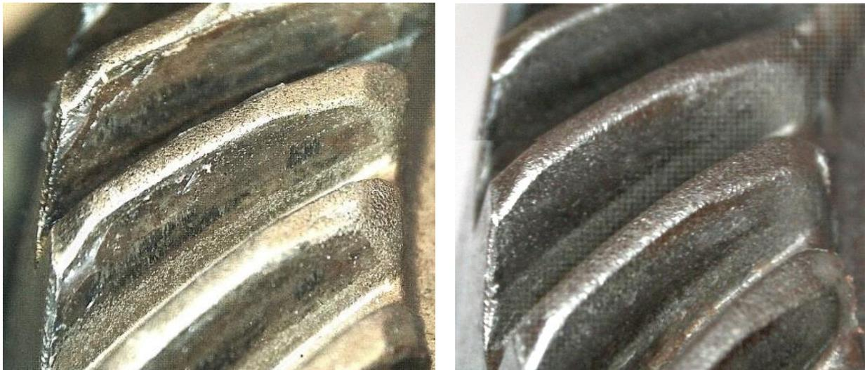
Abbildung 10: Tellerrad nach der Dauerlaufuntersuchung am Prüfstand (links) und aus einem handgeführten Versuch (rechts)
