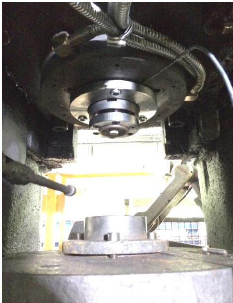
Abbildung 9: links: das Schmiedegesenk eingebaut in einer Exzenterpresse, rechts, das mit dem Gesenk geschmiedetes Bauteil
