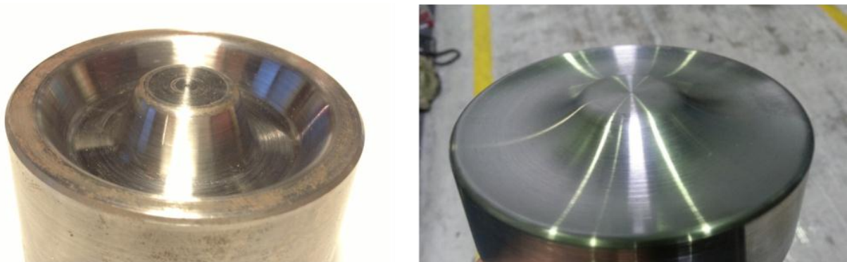
Abbildung 5: konturierte Gesenke zur Verschleißuntersuchung
