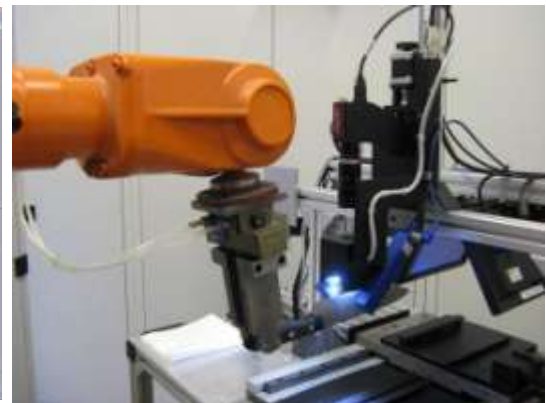
Abb. 3: Gesamtprüfstand mit Roboterzuführung, Watenprüfstand (Vordergrund) und spektrales Doppelgoniometer (Hintergrund)
