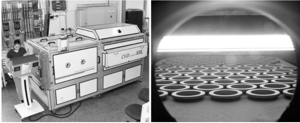
Abbildung 3: CVD-Diamant-Beschichtungsanlage des Fraunhofer IST (CVDiamond XXL) mit einer nutzbaren Fläche von bis zu 500 mm x 1000 mm.
