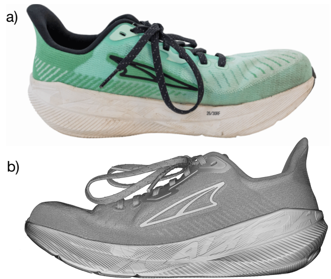
Abb.5: Der Altra Experience Flow, a) linker Schuh mit Sicht auf die Innenseite, b) Röntgen-CT-Aufnahme des rechten Schuhs mit Sicht auf die Innenseite
