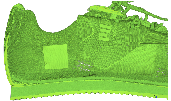
Abb.14: Schnittaufnahmen entlang der Fußachse durch den Puma evoSPEED Star 9, Mittelfuß und Fersenbereich in Falschfarbendarstellung zur einfacheren Differenzierung einzelner Komponenten auf Basis der Dichten
