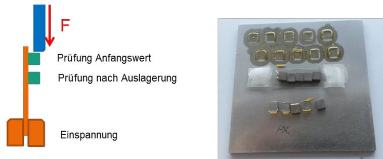
Abbildung 3: Druckscherprüfung schematisch und Beispiel eines geprüften Probekörpers
