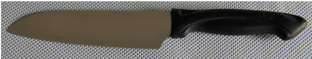
Abbildung 3: Messerklinge aus 1.4116 nach 125 Spülzyklen mit phosphathaltigem Reiniger
