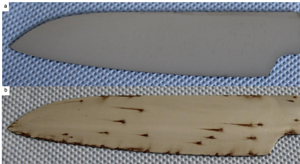
Abbildung 3: Gepliestete und passivierte Santoku-Messerklingen aus X46Cr13 (Passivierung: 10 min in 2,0%-Zitronensäure bei 70°C): a) nach 125 Spülmaschinezyklen b) nach 6 h Wechselltauchen in 1%-NaCl-Lösung bei 60°C
