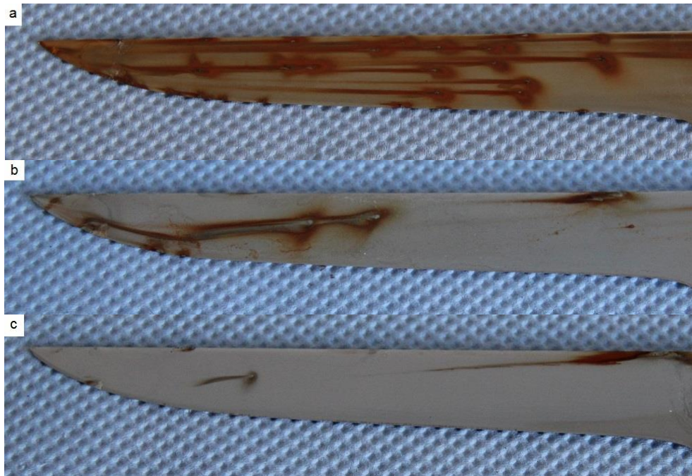
Abbildung 4: Polierte Santoku-Messerklingen aus X45CrMo15 nach dem Wechseltauchtest: a) ohne Passivierung b) Passivierung: 10 min in 4,0%-Phosphorsäure bei 70°C c) Passivierung: 30 min in 4,0%-Phosphorsäure bei 90°C
